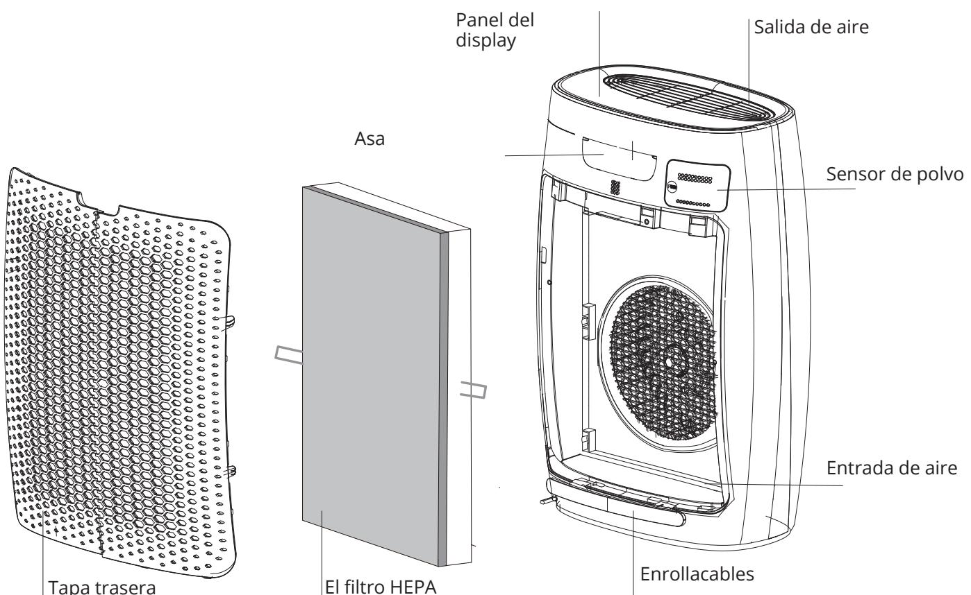
Para facilitar el almacenaje, si no tiene previsto utilizar el aparato durante un tiempo prolongado, puede enrollar aquí el cable
