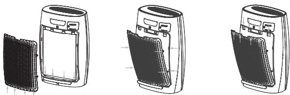
Inserire il fermo inferiore dell'alloggiamento posteriore nello slot alla base del corpo dell'unità.
