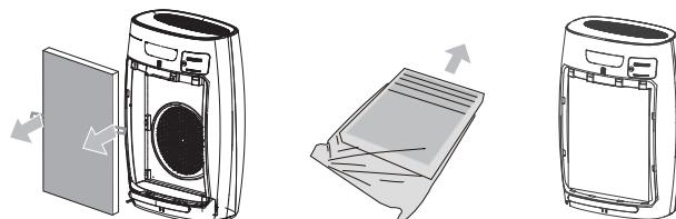
Tineți elementele de filtrare de pe ambele părți ale curelei, scoateți elementele de filtrare
