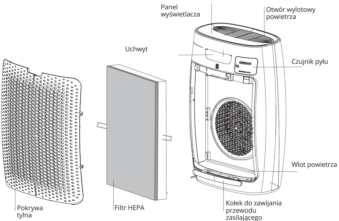
W celu łatwiejszego przechowywania podczas dłuższej przerwy w użyciu można zawinąć przewód zasilający w tym miejscu
