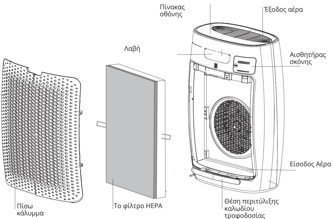
Για εύκολη αποθήκευση, σε περίπτωση μακροχρόνιας αδράνειας, μπορείτε να τυλίξετε το καλώδιο τροφοδοσίας εδώ
