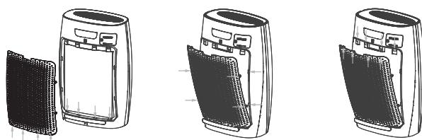
Τοποθετήστε το κάτω κλιπ του πίσω περιβλήματος στην υποδοχή στο κάτω μέρος του σώματος
