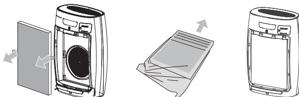
Tenez les éléments filtrants des deux côtés de la courroie, retirez les éléments filtrants
